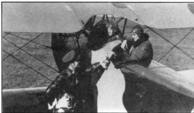
LINKS : Phönix C-I 121.102 im tschechoslowakischen Fliegerregiment Nr. 2 in Olomouc (Ol-mütz). Interessant ist die umgebaute Beobachterkabine, in der man auf den Drehring für das Maschinengewehr verzichtet hat.
